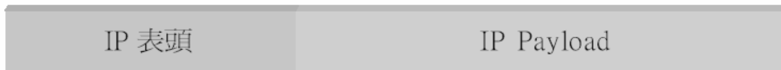
圖 8-02 IP 封包的結構
