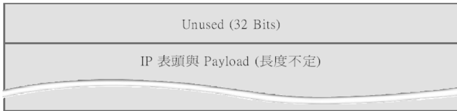
圖 9-12 傳送逾時封包中的 ICMP 資料之結構
