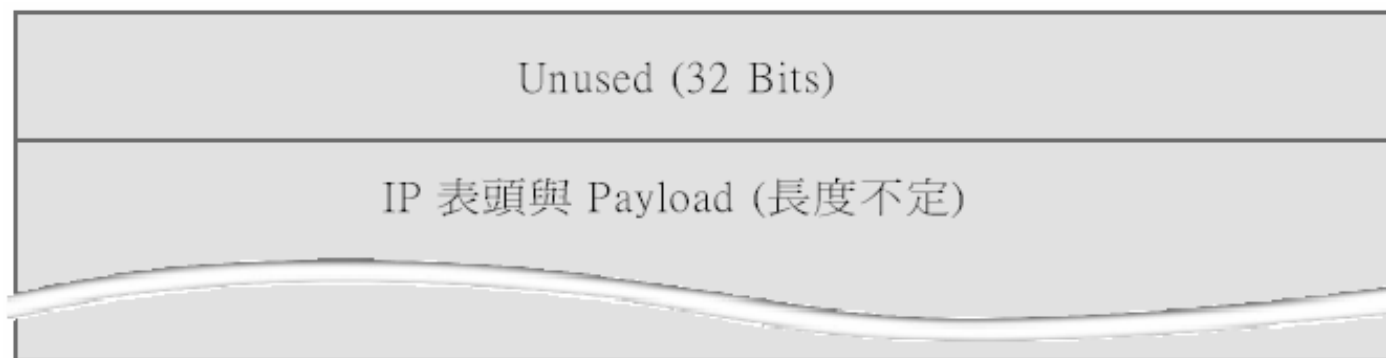
圖 9-09 降低來源傳輸速度的封包中的 ICMP 資料之結構
