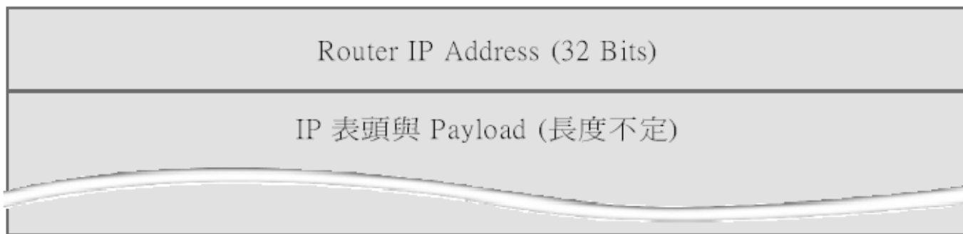
圖 9-11 重新導向封包中的 ICMP 資料之結構
