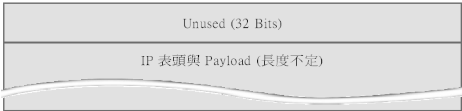
圖 9-08 無法送達目的封包中的 ICMP 資料之結構
