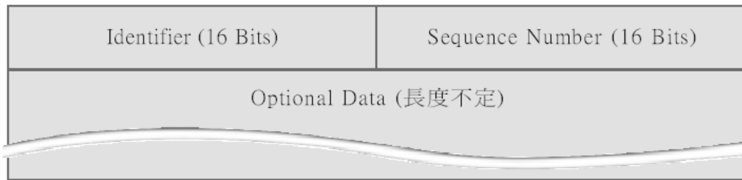
圖 9-07 回應要求與回應答覆封包中的 ICMP 資料之結構
