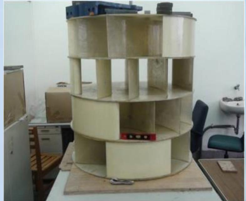
風車四階葉片轉子**複合材料**膠合製程
