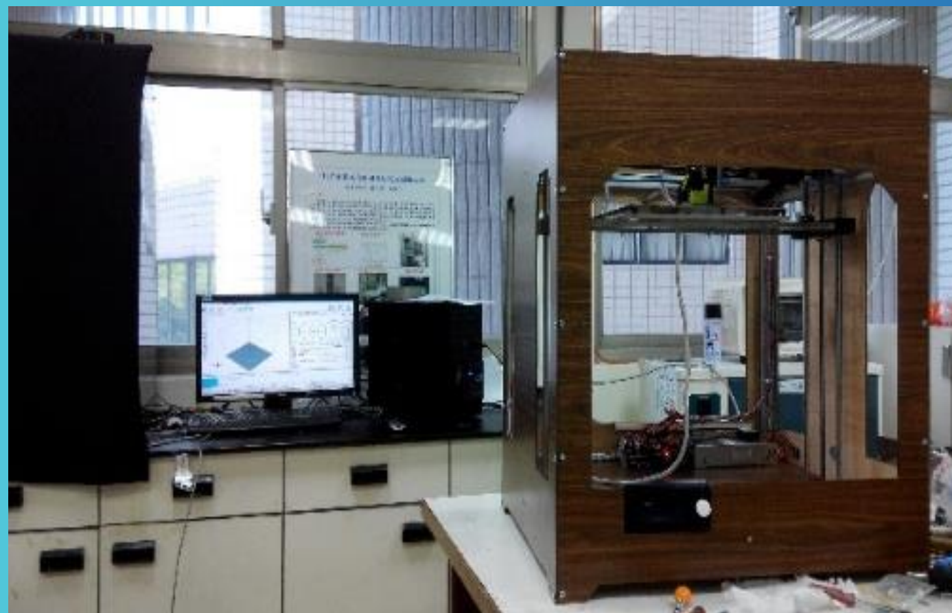
自組3D列印機台(塑料製程)
