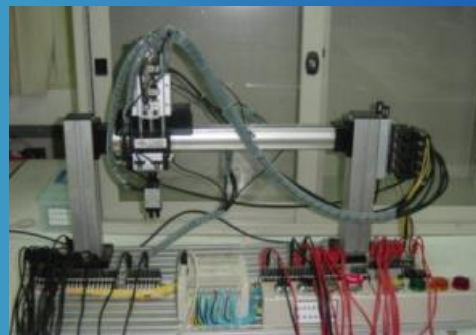
拱型氣壓式機械手模組
