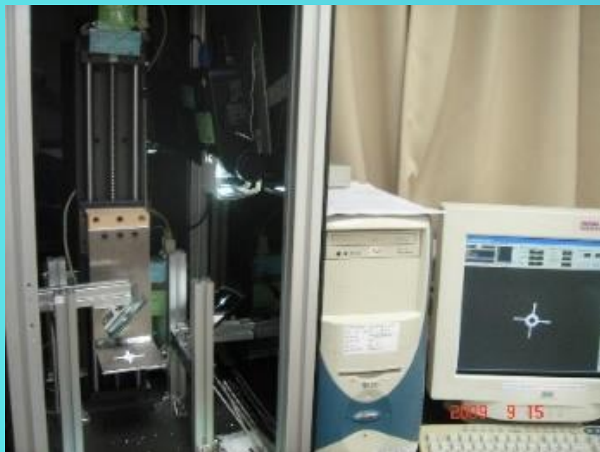
自組3D列印機台(液態製程)
