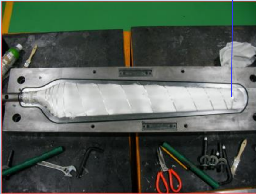
複合材料風車葉片預成形物與模具配置
