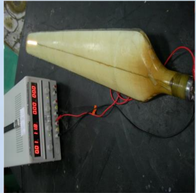
複合材料水平軸風車葉片與LED燈泡一體成形
