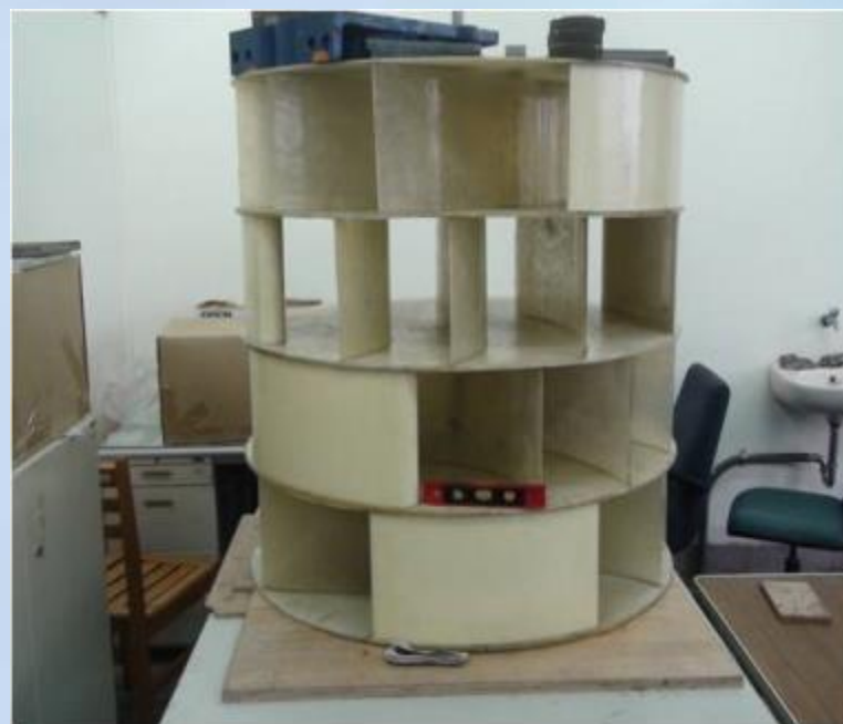
風車四階葉片轉子 複合材料 膠合製程
