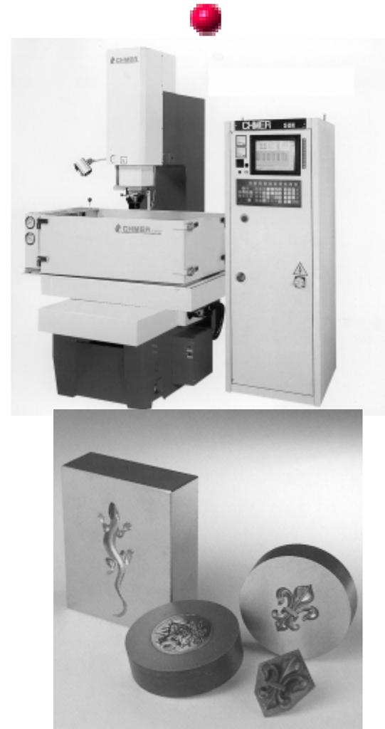
圖2-5 型雕放電加工機及其加工成品
