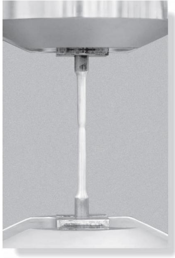
鋼試片在破裂前一刻所發生之典型頸縮形式。
