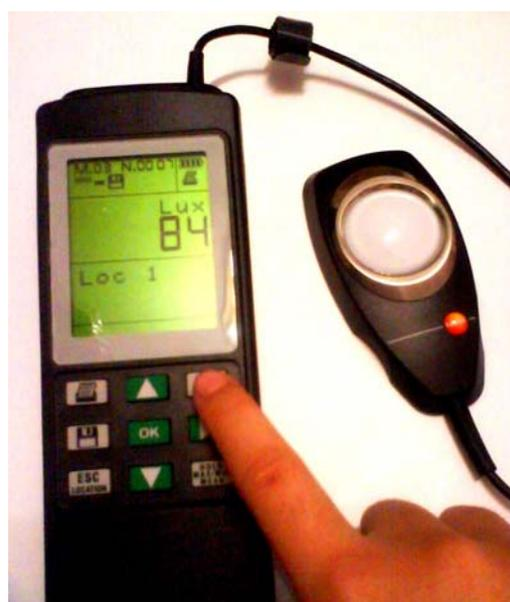
電源開啟後，即可馬上測量出感應器感應的光照強度的數值。
