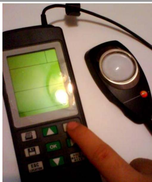
將感應器放置在平面上，以方便測量該空間的光照強度。
