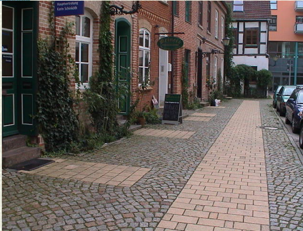
圖3 具有滲水功能的社區塊石鋪面道路
