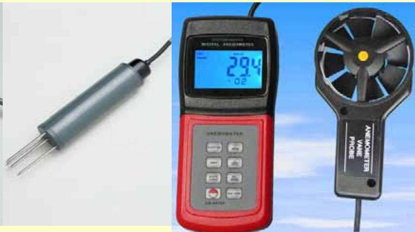
圖 風速偵測器
