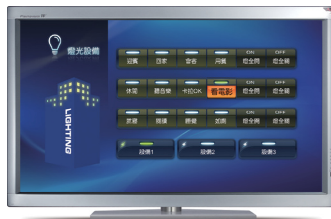
電視操作介面 - 情境燈控 看電影模式
