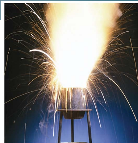
鋁熱劑反應所釋出的高溫被用來切割或焊接鐵軌。
