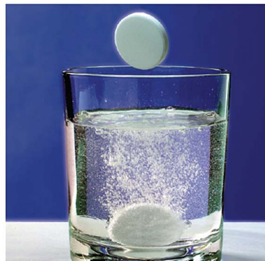
圖 5.2 化學反應可形成具有不同性質的新生成物。如制酸劑 ( \text{NaHCO}_3 ) 在水中會生成二氧化碳 ( \text{CO}_2 ) 的氣泡。
