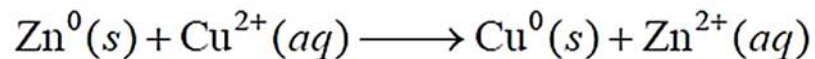
圖 5.7 在此單取代反應中， \text{Zn}^0(s) 提供 2 個電子將 \text{Cu}^{2+} 還原成 \text{Cu}^0(s) ，它自己則被氧化成 \text{Zn}^{2+} ：
